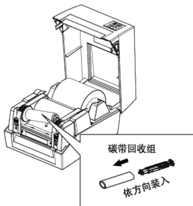
3.将碳带经由打印头从下往上拉,将碳带前缘黏在碳带回收纸轴上,再卷绕 2~3 圈,转动碳带回收轮,将碳带回整。
