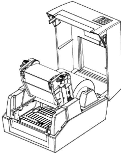
4.将打印头组压下并固定,再闭合顶盖。
