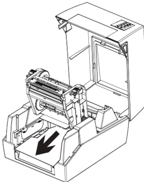
3.按照下图图示方向关闭打印头组后关闭顶盖。
