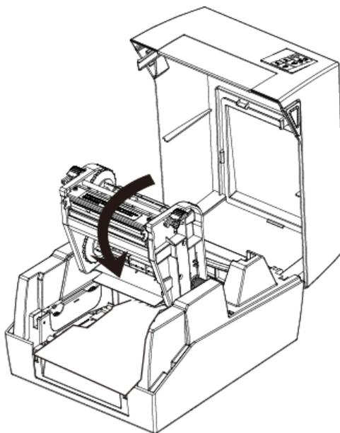
4.向下按顶盖，直到顶盖咔一声锁闭。
