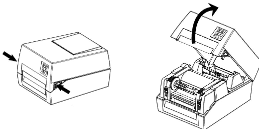
2. 配合纸卷内径，将纸卷装入纸卷轴心，再将纸卷组由上往下装入打印机内。
