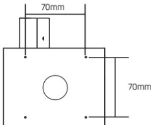
注：固定标记孔位时，需注意人脸识别设备的识别方向，调整合适角度后再进行定位标记。若尾线不采取穿管预埋方式铺设，可不开穿线孔。
