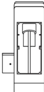
(2) 将测温模组导线穿过支架侧面穿线孔，并将测温模组对准相应的固定孔位固定。固定完毕后，沿支架内腔穿线至下方开口处。（如图）
