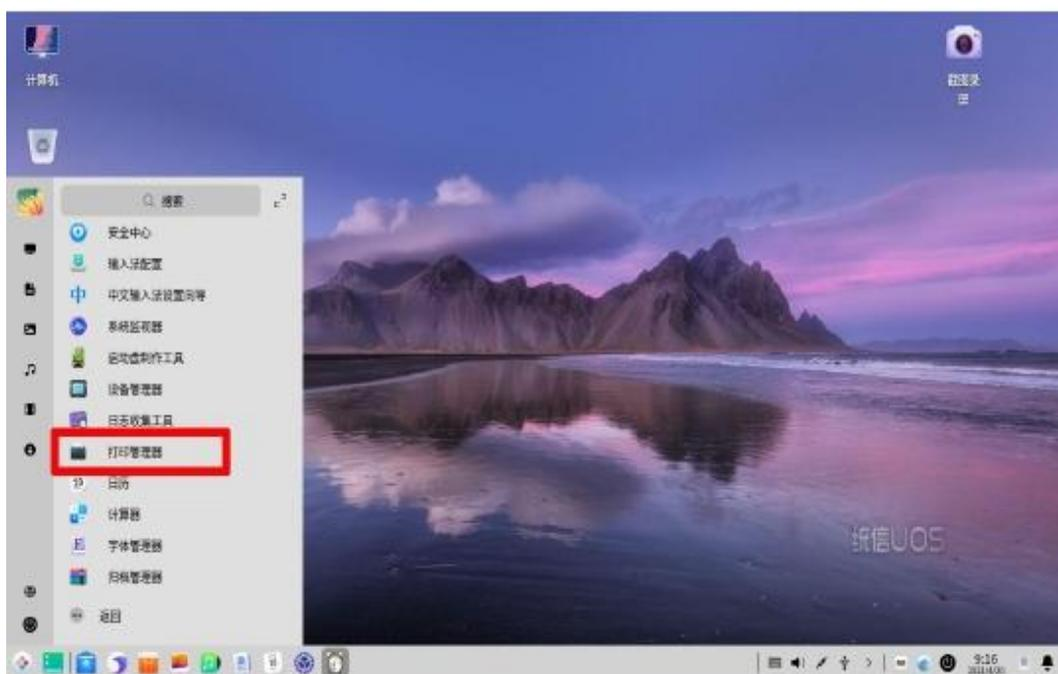
f. 弹出打印机设备窗口，鼠标左键点击“+”添加打印机。
